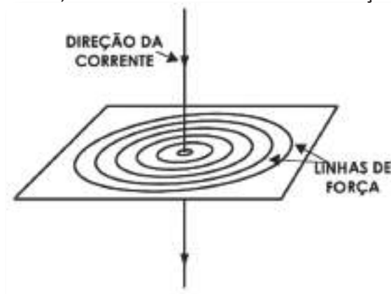
Fig. 4: Campo magnético provocado pela corrente elétrica
